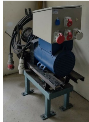
Stationäres Zapfwellenaggregat Foto: LfL
