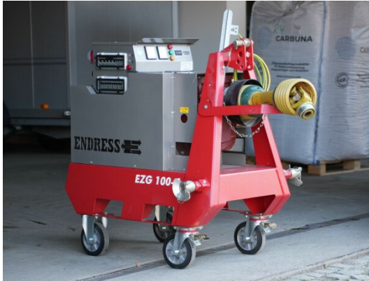
Mobiles Zapfwellenaggregat Foto: LfL
