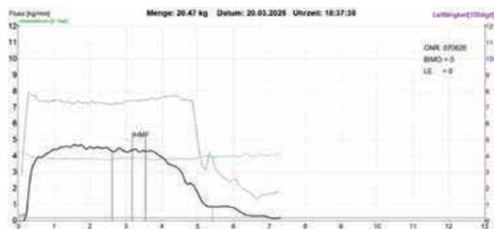
Die Milchflusskurve informiert über die Melkbarkeit des Einzeltiers und gibt Aufschluss über Schwachstellen in der Melkroutine und technische Mängel der Melkanlage.
