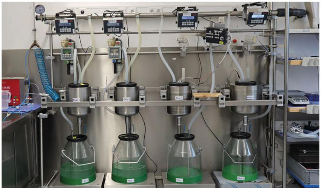
Modell-Melkstand zur Durchführung von Wassertests in der LactoCorder-Werkstatt
