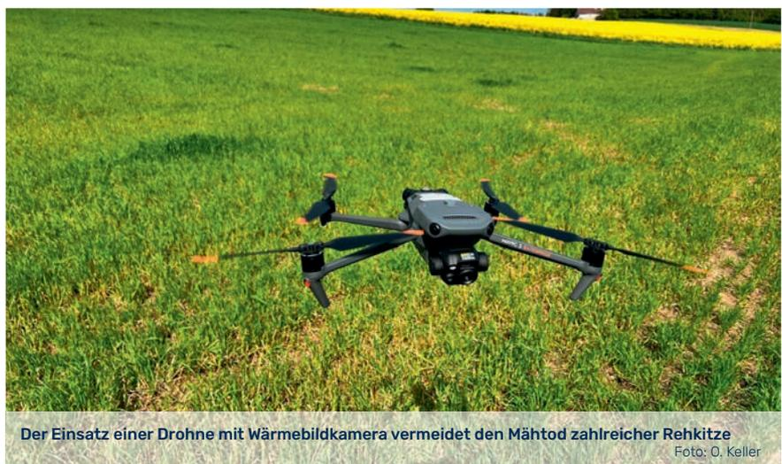
**Der Einsatz einer Drohne mit Wärmebildkamera vermeidet den Mähtod zahlreicher Rehkitze**
