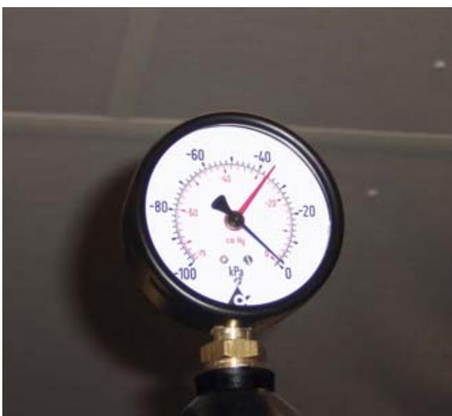
Vakuummeter mit aktueller (schwarz) und angestrebter (rot) Vakuumhöhe
