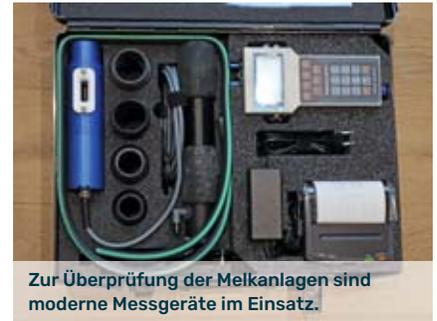
Zur Überprüfung der Melkanlagen sind moderne Messgeräte im Einsatz.
