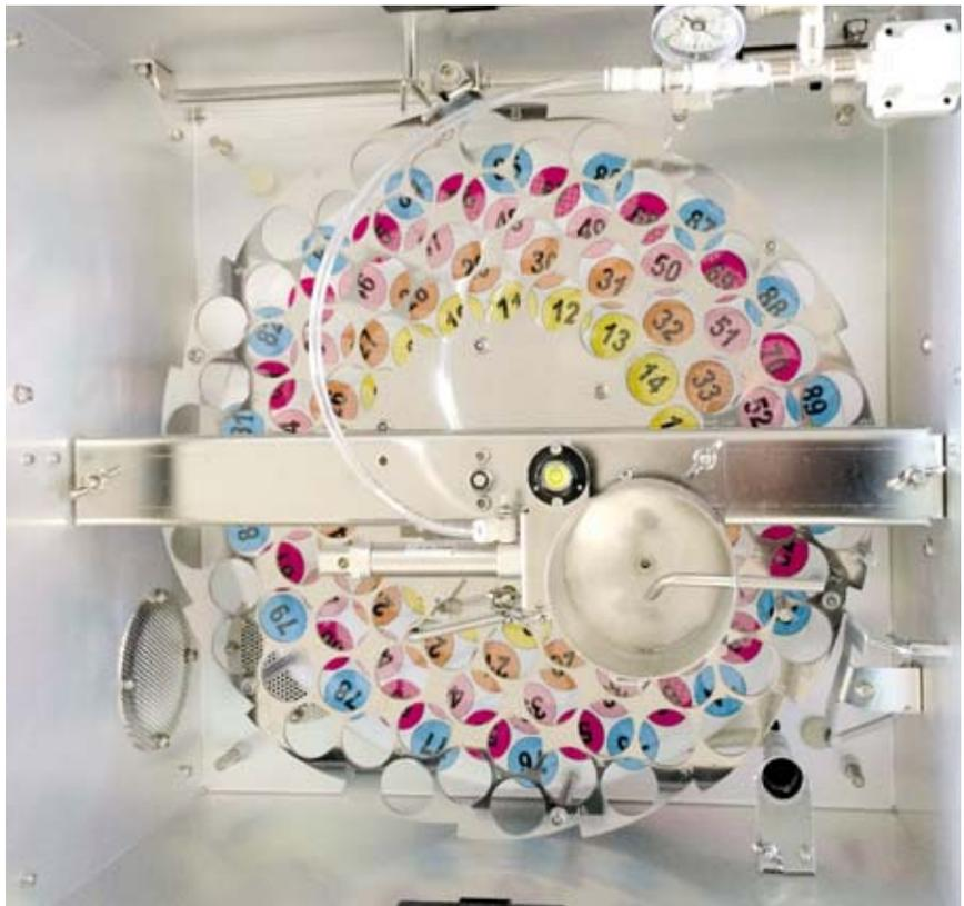
LKV-Leistungsoberprüfer. Das Gerät umfasst 90 Probeflaschen und somit gehört der meist nächtliche Rahmenwechsel während des Pro-
