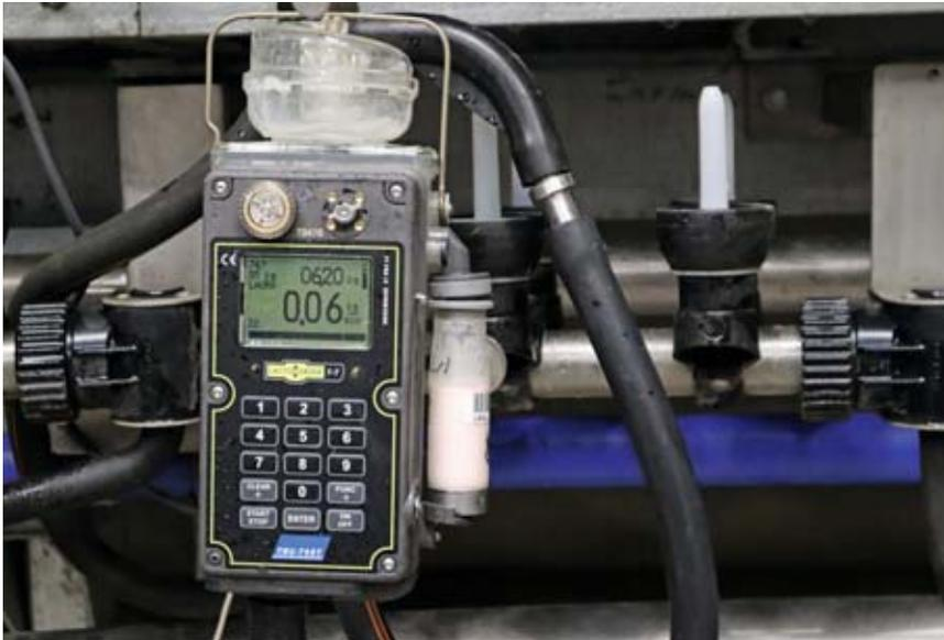
Milchleistungsprüfung – der neue LactoCorder im Einsatz
