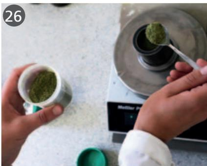
26 Einfüllen der gemahlenen Probe in die Presse
