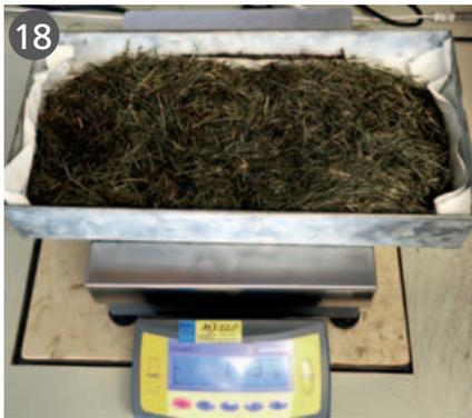
18 Rückwaage der getrockneten Probe
