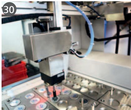
30 Der Probennehmer saugt die Probe an, um sie zu zur Messstation zu transportieren
